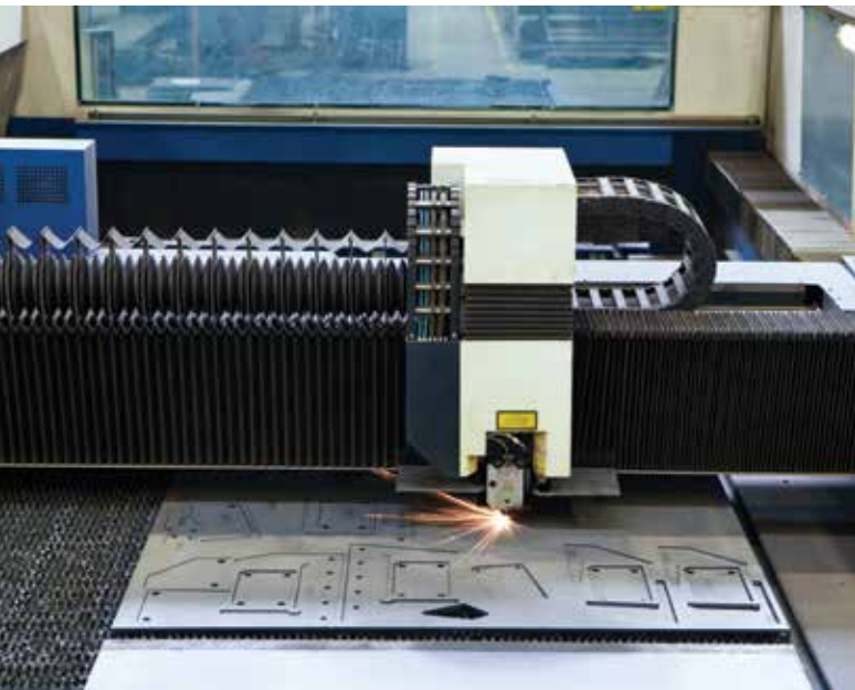
Bei Unger werden die Informationen direkt von Tekla Structures an die Fertigungsmaschinen übertragen. © Renée Del Missier/Unger Steel Group
